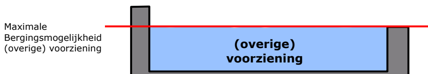
Figuur 1c: Schematische weergave maximale bergingsmogelijkheid zoals genoemd onder c.
